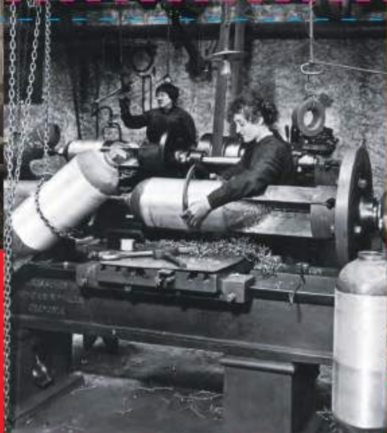
Tournage des bombes effectué par deux ouvrières des Ateliers Doucayer et Vialat, Grenoble, 1914-1918. Collection Archives départementales de l'Isère
